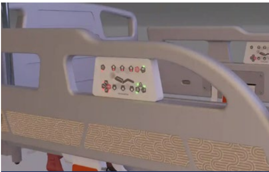
Doble control en la baranda derecha
